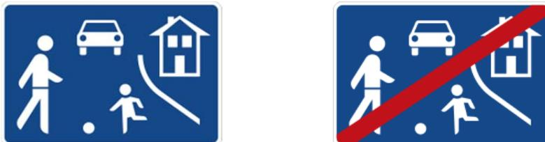
Zum anderen aber auch an der baulichen Gestaltung: Die Straßen sind regelmäßig niveaugleich ausgebaut; Gehweg und Fahrbahn sind nicht voneinander abgegrenzt, sondern es besteht eine Mischfläche. Am Anfang/Ende des Bereiches gibt es einen durchgehenden, abgesenkten Bordstein – vergleichbar mit einer Grundstücksauffahrt.
